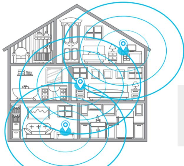
Se recomienda colocar el WIFI-MESH a mitad del camino entre el área con baja señal inalámbrica y el dispositivo que genera dicha señal.
