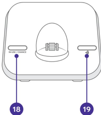
**18. LED de línea ocupada e indicador de carga (IN USE / CHARGE)**
