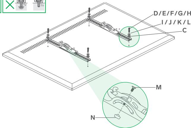
Coloca en cada una de las barras, la mariposa (N) y el tornillo (M) que fijarán la posición de inclinación.
