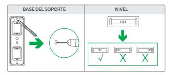
Al realizar las perforaciones, ten cuidado de que no existan tuberías ocultas con cableado eléctrico, gas o agua.
