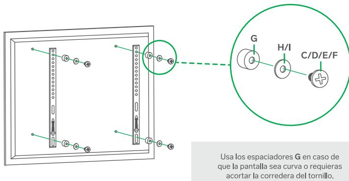
**3** Instala la pantalla sobre el soporte. (Afloja los tornillos de seguridad, para montar la pantalla sin dificultades. Aprieta nuevamente los tornillos, para asegurar las barras).
