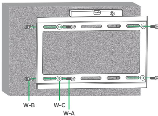
Si deseas instalar el soporte en madera, omite la pieza **W-B** y usa una broca de 3 mm de diámetro.
