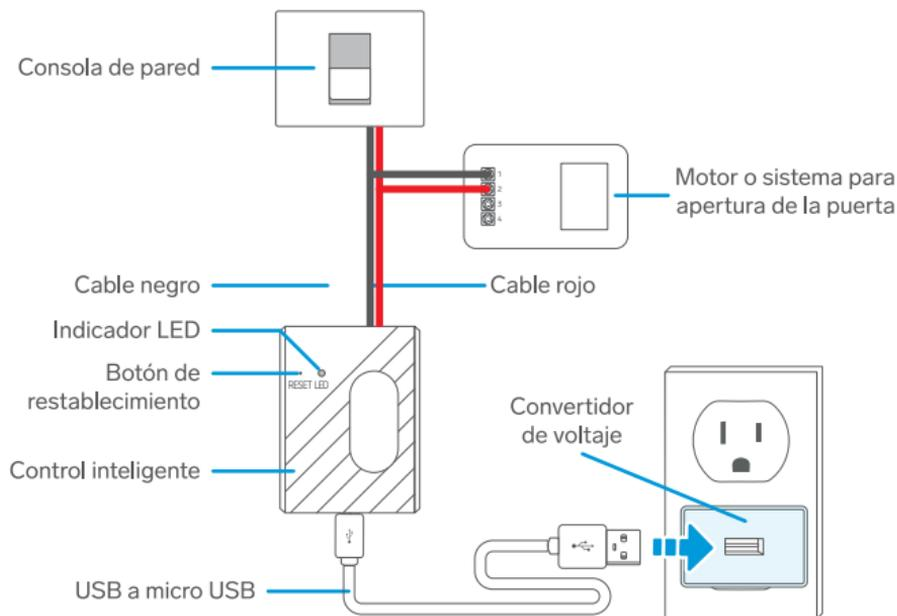
Coloca el cable para motor en la salida **Motor** del control. Después, coloca cada cable (rojo y negro) en las mismas terminales que el botón alámbrico de pared.
