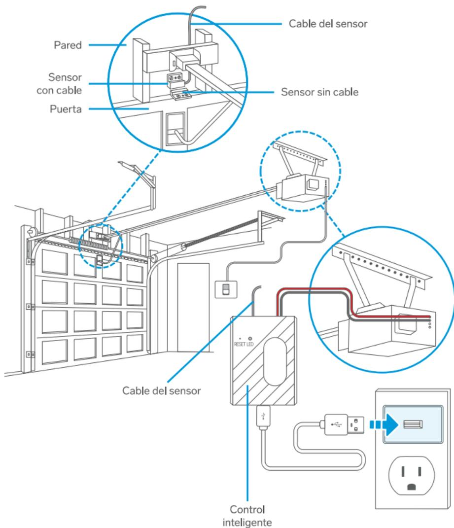
Conecta el cable del sensor en la entrada **Sensory** del control.
