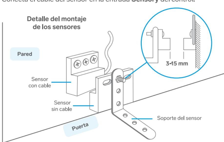
Si es difícil instalar los sensores con los tornillos, usa las cintas doble cara para fijarlos.
