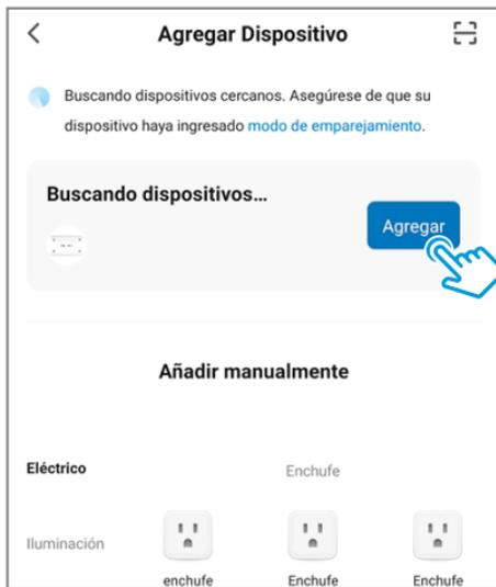
Si el dispositivo no es localizado automáticamente, mantén presionado el botón de accionamiento por aproximadamente 5 segundos o prende y apaga alguno de los interruptores conectados en S1 o S2 6 veces continuas dentro de 5 segundos, y espera a que el sistema se ponga en modo de emparejamiento. Posteriormente, repite desde el paso 2.
