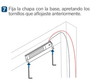
**7** Fija la chapa con la base, apretando los tornillos que aflojaste anteriormente.
