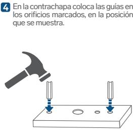
**4** En la contrachapa coloca las guías en los orificios marcados, en la posición que se muestra.
