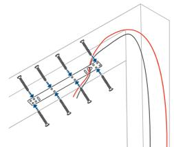
**5** Conecta los cables de alimentación con los cables que instalaste anteriormente en la chapa.
