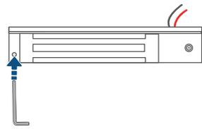
**2** Introduce la llave en los orificios y afloja los tornillos que están dentro, para retirar la base metálica de la chapa.
