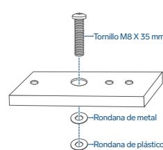
**6** Coloca la contrachapa en la puerta, haciendo coincidir las guías y el tornillo con sus respectivos barrenos. Del otro lado, asegura la contrachapa con la tuerca tipo remache.
