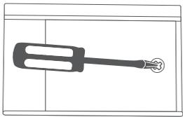
**2** Retira la cubierta. Puedes auxiliarte con un desarmador plano y delgado para hacer palanca.
