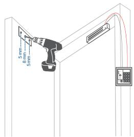
**3** Realiza los barrenos laterales con una broca de 5 mm, a una profundidad de 1 cm
