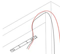
**4** Fija la base con las 8 pijas de 3/4 en los orificios indicados.
