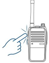
El indicador del radio encenderá en rojo mientras se transmite y en verde cuando reciba una transmisión.
