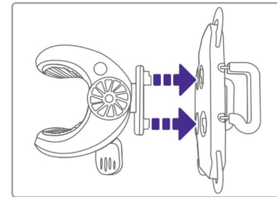
Si deseas retirar el soporte de la pinza sujetadora, presiona el seguro (como se muestra en la imagen), y desliza la pinza hacia arriba.
