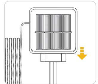
Elige una posición adecuada para el panel solar y fíjalo apretando el tornillo de ajuste de ángulo.
