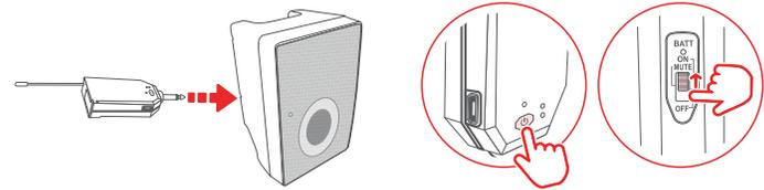
Cuando termines de usar el equipo, apaga los micrófonos y el receptor.
