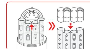
Asegúrate de colocar las pilas con la polaridad como se indica en el contenedor.
