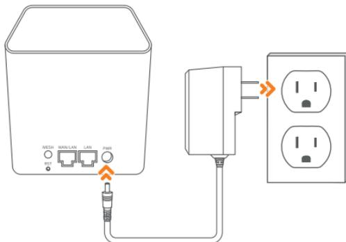
Los módulos se sincronizarán entre sí automáticamente, una vez conectados a la corriente eléctrica. Esto podrá identificarse cuando el indicador LED del satélite se mantenga iluminado en color verde; si esto no sucede, presiona el botón **RST** en el satélite por 10 segundos y espera a que se efectúe la conexión (en un tiempo aproximado de 5 minutos).
