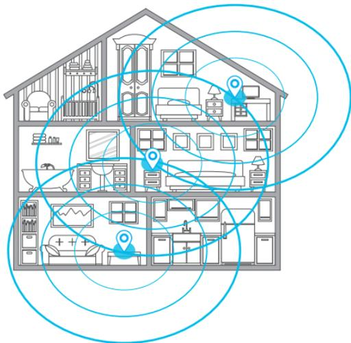
Se recomienda colocar el módulo a mitad del camino entre el área con baja señal inalámbrica y el dispositivo que genera dicha señal y probar la conectividad; si esta es mala o deficiente debido a los obstáculos, se deberá ir acortando el espacio entre los equipos hasta obtener una mejor conectividad.
