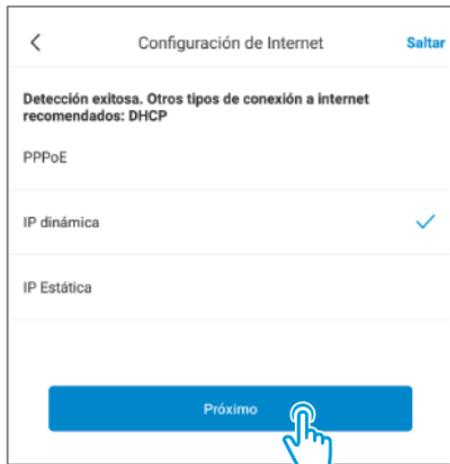
El sistema identificará y seleccionará automáticamente el tipo de conexión (usualmente es **IP dinámica**). Si no conoces el tipo de conexión, mantenla de esta manera; pero si es una diferente y conoces sus parámetros, elígela e introduce los datos necesarios.
