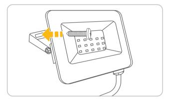
Ajusta la posición de inclinación aflojando y apretando los tornillos laterales.
