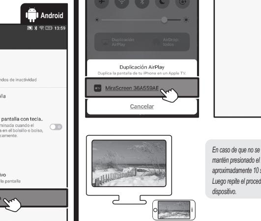
En caso de que no se pueda establecer la conexión, mantén presionado el botón del adaptador durante aproximadamente 10 segundos para reiniciarlo. Luego repite el procedimiento para vincular el dispositivo.
