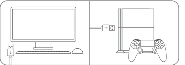
**2** Mantén presionado el botón **START** y, sin soltarlo, inserta el plug micro USB en el puerto del control. *Los 4 indicadores LED comenzarán a destellar en pares.*
