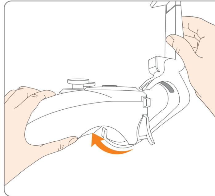
**3** Separa la pinza y coloca tu celular. (Hasta 8 cm de ancho).
