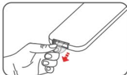
Para reemplazar la pila, abre el compartimento. Coloca una nueva pila tipo botón CR2025. Asegúrate de que la polaridad de la pila esté en la posición correcta.
