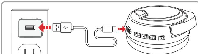
*Durante el proceso de carga, el LED indicador permanecerá encendido en rojo; cuando la carga finalice, cambiará a color azul.*
