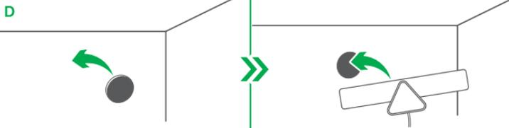
Selecciona el área donde vas a instalar la antena y coloca el velcro. Debe ser una superficie lisa y estar libre de polvo. Después adhiere la antena en el velcro de la pared.
