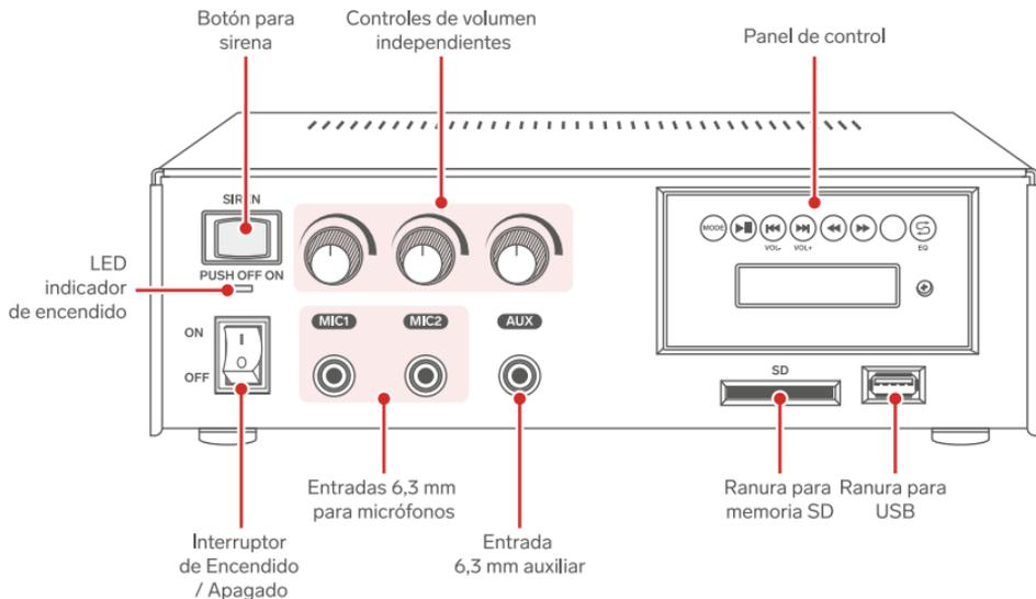
**Nota:** La perilla de volumen AUX funciona para controlar el volumen de algún reproductor conectado a la Entrada 6,3 mm AUX o para controlar el volumen de reproducción MP3.
