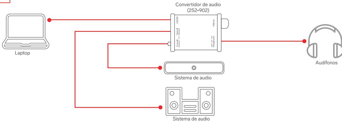
Al conectar el convertidor, los controladores se cargarán automáticamente.
