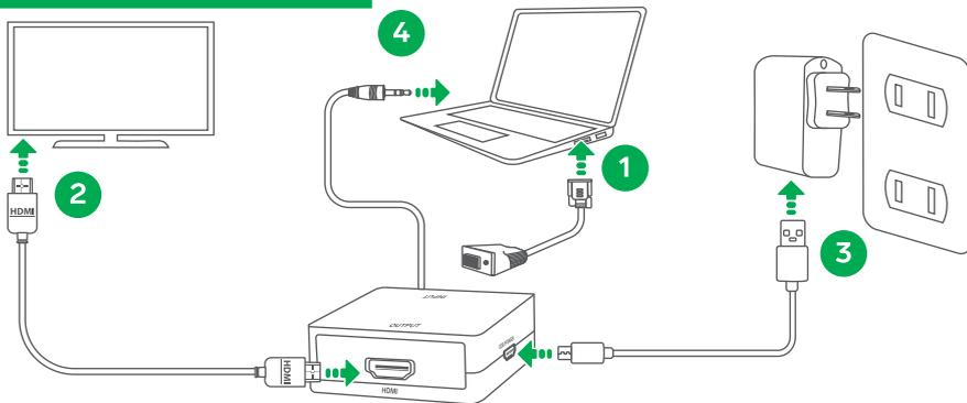
1. Conecta un cable<sup>1</sup> VGA entre la fuente de video y el convertidor.
